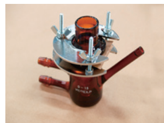
In vitro 皮膚透過性試験で使用する静的拡散セル（Franzセル）
